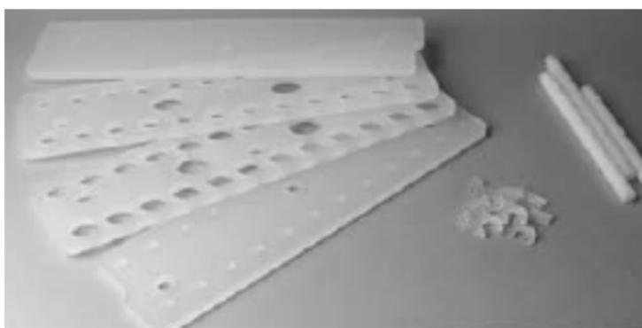
Вертикальная регулировка платформы с выемками, на которых покоятся днища пробирок, позволяет пользователю адаптировать кассету к пробиркам разной высоты
