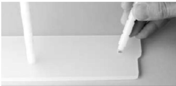
**А)** Положите основание на плоскую поверхность так, чтобы уступка находилась справа снизу. Прикрепите к основанию три крепежных стержня. Правильная ориентация углубления необходима, чтобы полка не касалась сборки вакуумметра при помещении в емкость.
