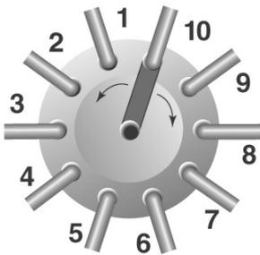
Кран представляет из себя автоматическое программно-управляемое устройство позволяющее переключать поток из любого из 10 периферийных портов на центральный порт. В Модуле ввода SIS-001.5 это позволяет программно-, и в соответствии с реализуемой методикой измерений переключать поток различных образцов и калибровочных растворов в петлю инжектора.
